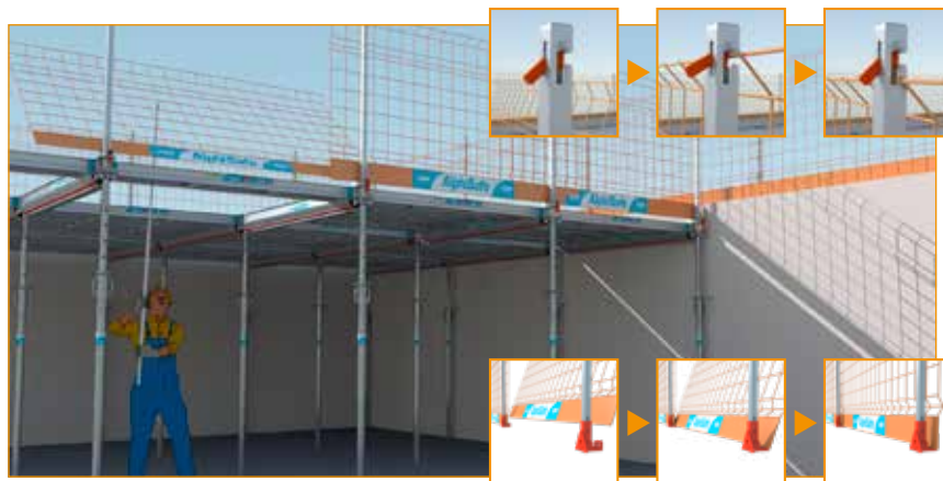
Das Gitter wird am Fallkopf mithilfe einer Haltenase gegen das Anheben nach oben und durch Haken am Fuß gegen Verdrehen gesichert.
