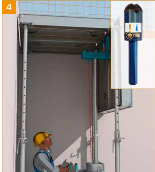
4 - Elever le panneau jusqu'à la hauteur souhaitée : **l'arrêt supérieur doit être aligné sur le haut du panneau déjà en place.**
