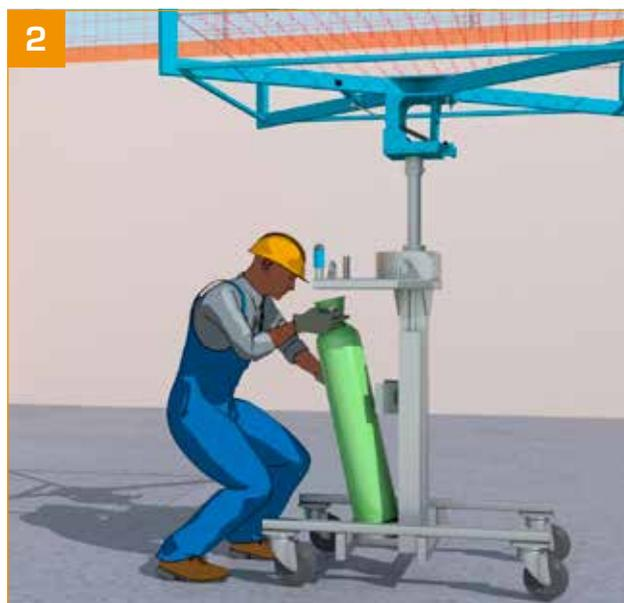
2 - Mettre en place une bouteille sur l'appareil, la sangler et la connecter au détendeur.
