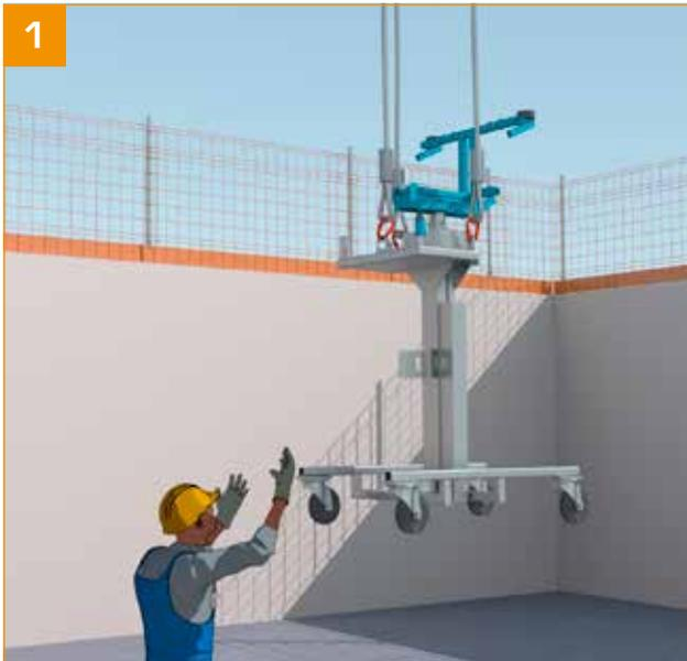
1 - Amener le MaxUp, sans la bouteille d'air comprimé, sur la zone de coffrage avec la grue.
