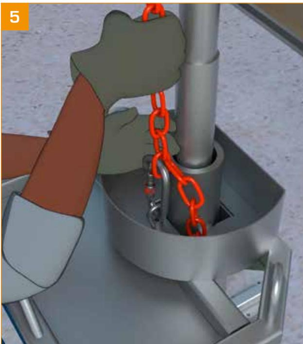
5 - Fixer la chaîne à l'aide du mousqueton pour conserver la hauteur souhaitée lors de la mise en place des panneaux suivants.
