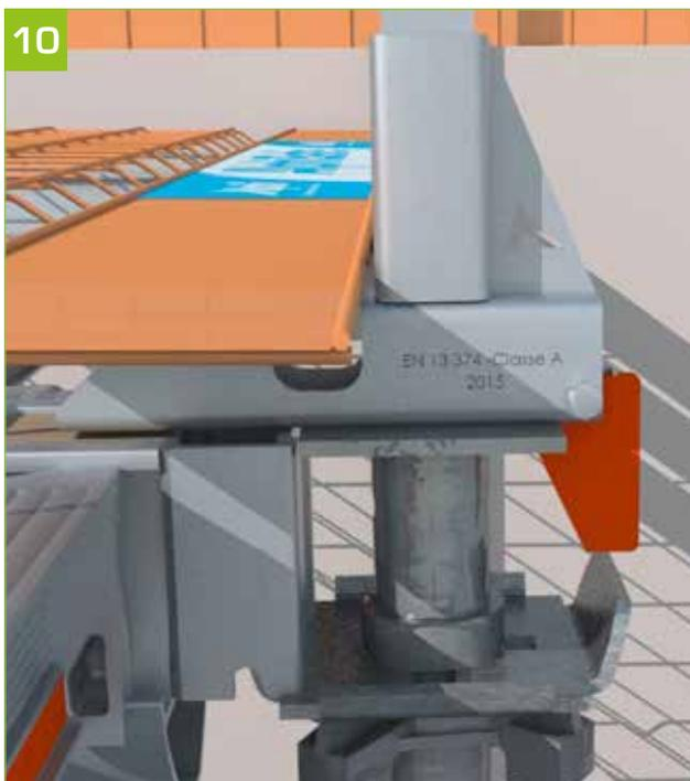
10 - Déplacer la grille AlphiSafe pour que la plinthe soit en contact avec l'adaptateur AlphiSafe.
