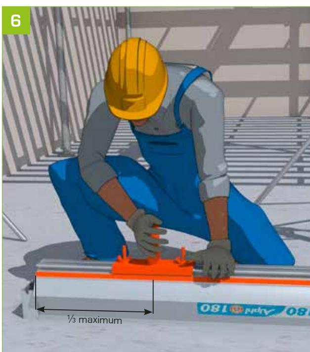
6 - Mettre en place la fourche de sécurité Anti-basculement (FSAB) sur la poutrelle primaire en porte-à-faux en ne dépassant pas la règle du  $\frac{1}{3}$  -  $\frac{2}{3}$  de la taille de la poutrelle.
