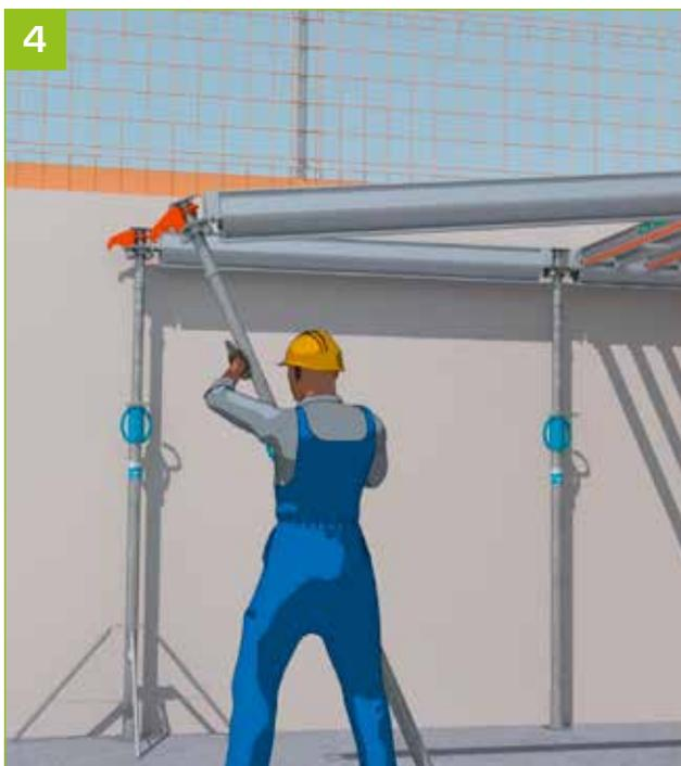
4 - Continuer la mise en place de la poutrelle primaire sur l'étau arrière, positionner l'étau avec bracon à l'extrémité de la poutrelle primaire.
