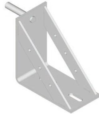
Le Suspension de solive 82 accueille une solive ou une poutrelle bois H20 d'une largeur < 82 mm et constitue ainsi une ossature pour des plates-formes de travail sécurisées, par exemple dans des cages et des trémies.
