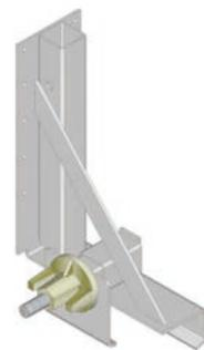
Le VT Pinche à poutrelle H20 sert à fixer un potelet sur des poutrelles H20 avec une épaisseur d'aile de 40 mm. En outre, cette fixation est utilisée comme butée pour le coffrage de rive.
