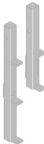
VT Fixation coffrage de rive et VT Fixation coffrage de rive Mini sont montés verticalement et servent à la fois de fixation pour le potelet et de butée pour le coffrage de rive. Grâce à un point de fixation unique, les possibilités d'utilisation et de fixation sont multiples, par exemple au moyen d'une tige d'ancrage.
